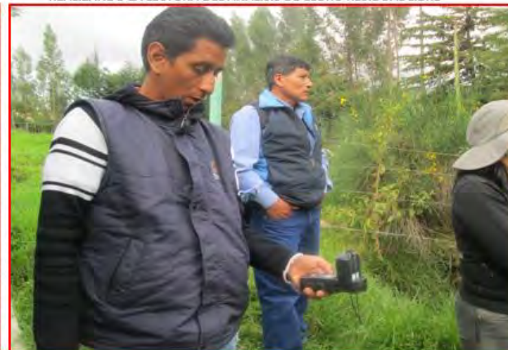
REALIZANDO LA LECTURA DEL ANÁLISIS DE CLORO RESIDUAL LIBRE
